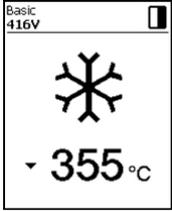
Schalten Sie die Heizung mit Taste *Heizung (38)* aus, damit die **Schweissdüse (13)** abkühlt.
