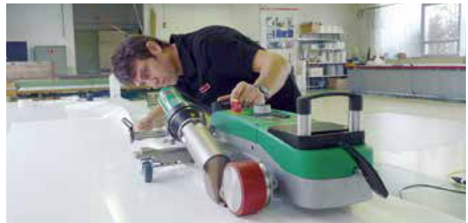
Einfaches Saum- und Kederschweissen mit dem Saum-/Kederkit.
