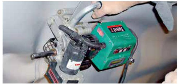
TWINNY T mit praktischem Quergriff beim Überkopfschweissen in einem Tunnel.
