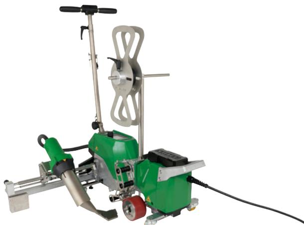
Der VARIANT 702 unterstützt das 50-mm-Bandschweißen und verschiedene Spannungen. Er lässt sich leicht von Band- zu Überlappschweißen umstellen und bietet so Flexibilität und optimale Leistung für den professionellen Einsatz.
