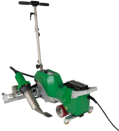
Das modulare Design des VARIANT 700 wechselt von Überlapp- zu Bandschweissung und schweisst bis zu 20 m/min, ideal für Planen, Zelte und Banner. Plug-and-Play-Räder, Lift-and-Weld-Technologie und Eco Mode erhöhen Effizienz.
