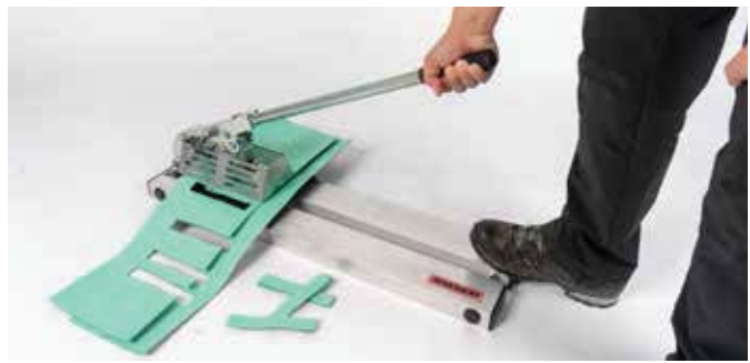
Prüflinge in einheitlicher Grösse, schnell hergestellt mit dem COUPON CUTTER 500.
