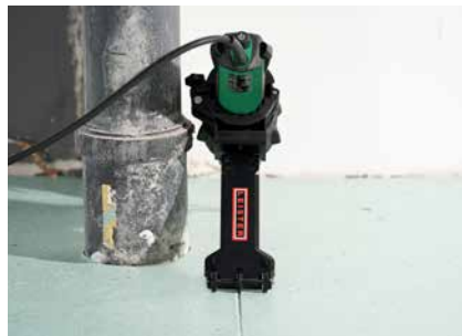
schmale Bauweise erlaubt randnahes Schweißen
