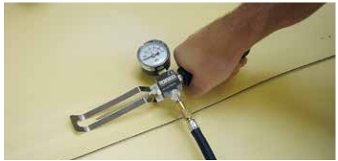
Testen der Dichtigkeit von überlappnähten mit Prüfkanal.
